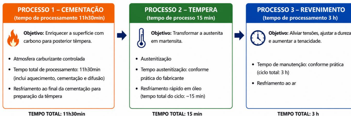
Figura 7 – Fluxo de processos tratamento térmico
